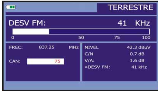
Figura 26.- Medida de la desviación instantánea de frecuencia.
