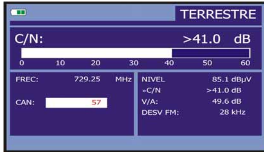
Figura 28.- Medida de la relación portadora/ruido (C/N).
