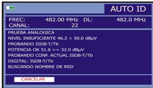
Figura 53.- Identificación automática de la señal.
