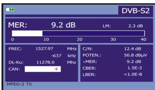
Figura 44.- Pantalla de medida del MER para señales DVB-S2 moduladas en QPSK/8PSK.
