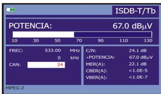
Figura 30.- Medida de la potencia de canales digitales.
