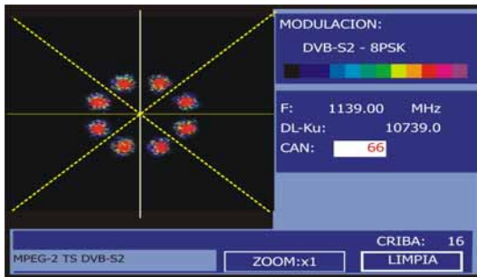
Figura 49.- Diagrama de constelación. Señal DVB-S2 (8PSK).
