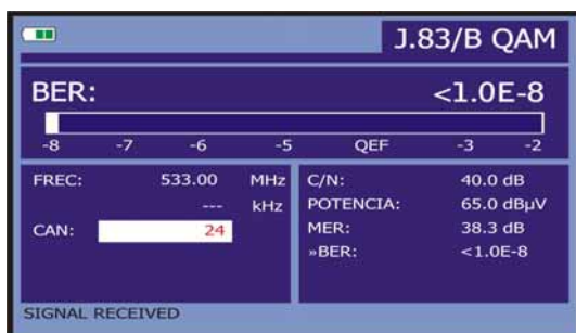
Figura 31.- Pantalla de medida del BER de señales moduladas en QAM Annex-B .
